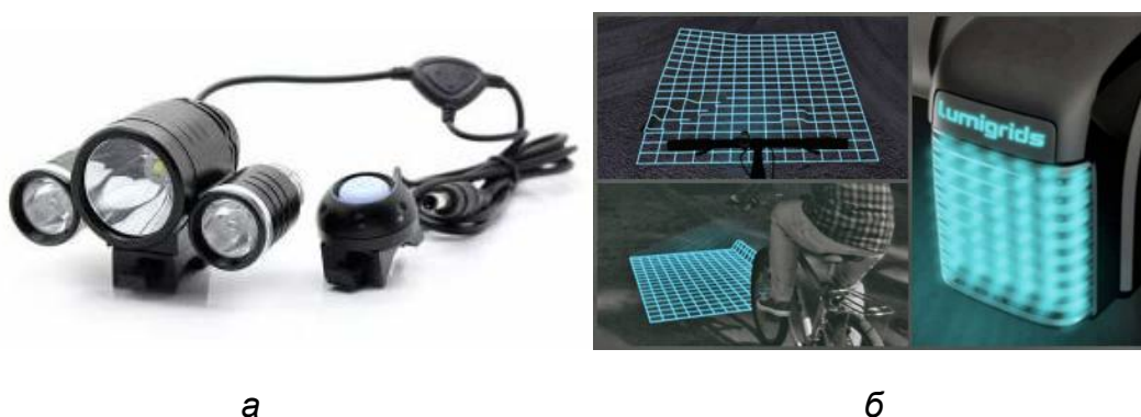
Рис. 3.3. Конструкции элементов световой сигнализации: а) фара TrustFire TR-D003 на трёх светодиодах; б) светодиодный проектор Lumigrids с тремя режимами работы с различным размером сетки: нормальный (140×180 мм), скоростной (140×260 мм), командный (300×200 мм) [37]
