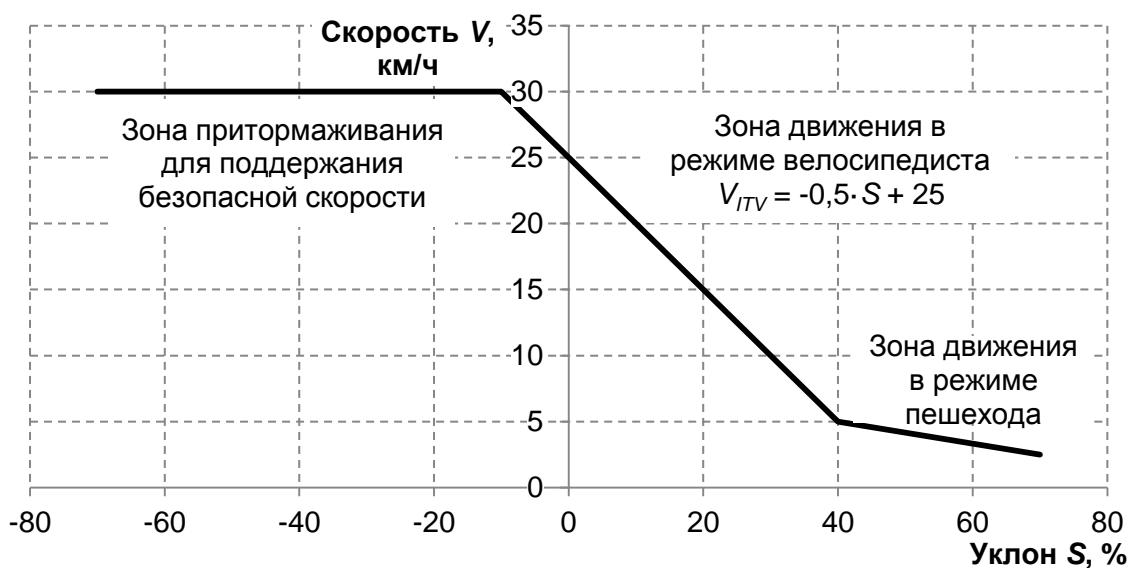
Рис. 4.7. Зависимость теоретической скорости движения велосипедиста V_{ITV} от уклона дороги S
